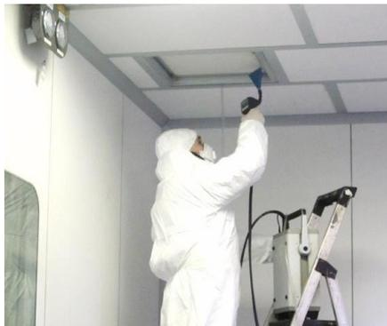
*Fase di Installation Qualification per la determinazione di efficienza puntuale dei filtri assoluti HEPA in classe H14 (Integrity PAO Test).*
